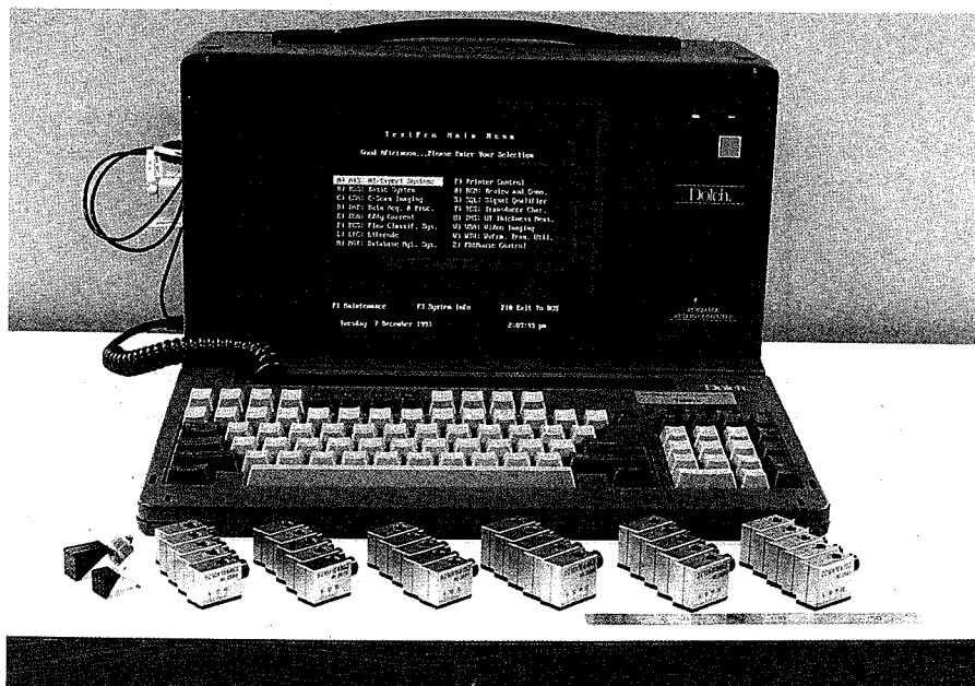
図 4 探傷器及び探触子の外観写真
