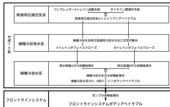
図6 計器用空気系故障の伝搬
