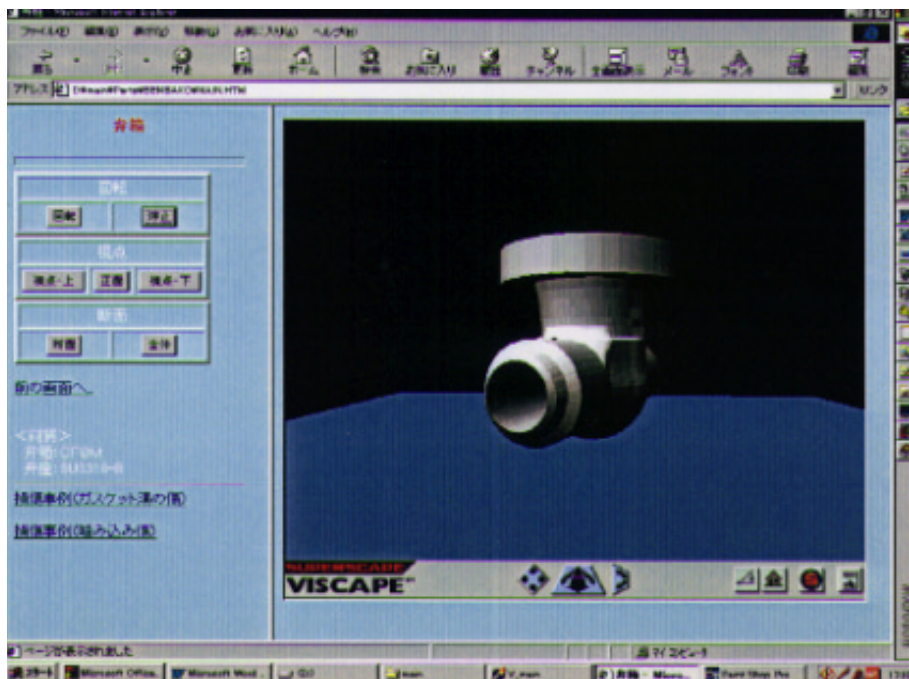
図3 部品形状表示（弁箱の例）
