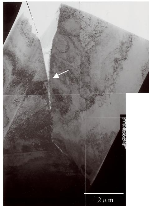
図6 き裂先端の低倍率TEM像
