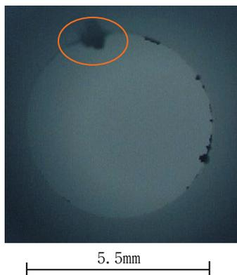
図13 試験片の円すい先端に生じた突起
