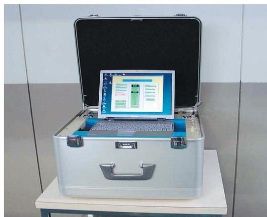
図2 オンライン部分放電モニター写真
