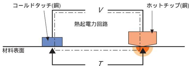
図1 熱起電力測定原理
