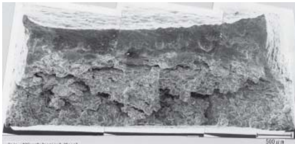
図4 SSRT試験後の破面のSEM観察結果 (600合金, 見かけの歪み速度: 5 \times 10^{-7}/s )
