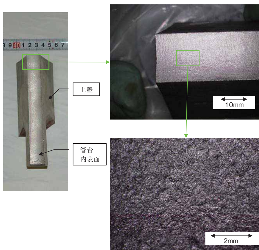
図6 管台内表面観察結果 (No.47 管台)
