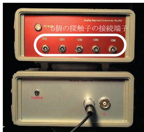
図8 5チャンネル超音波送受信器
