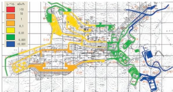
図1 原子力防災訓練時発電所構内放射線量率予測例 (平成20年度福井県原子力防災訓練時)
