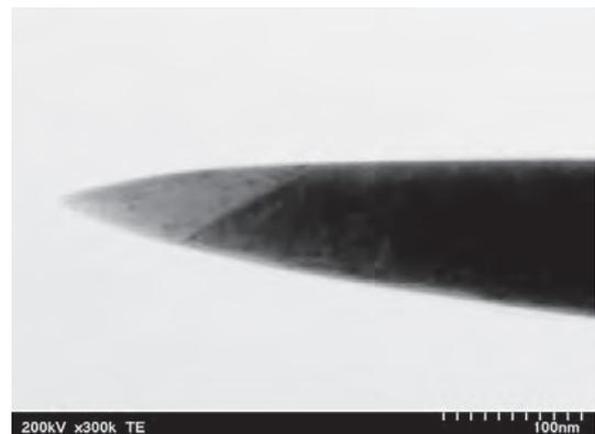
図1 結晶粒界を含むAPT分析試料のTEM像
