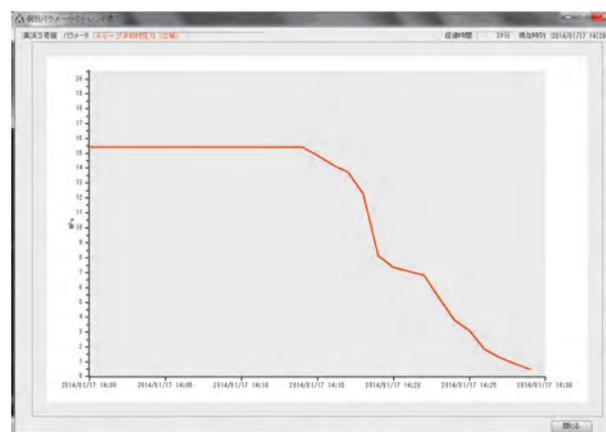
図9 トrend表示画面(原子炉圧力)
