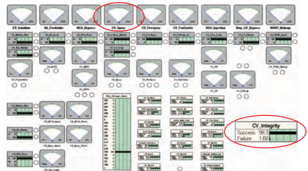
図29 炉心損傷時点におけるリスク評価例 (全交流電源喪失事象時、蒸気発生器への給水+格納容器スプレイ時の格納容器健全性)
