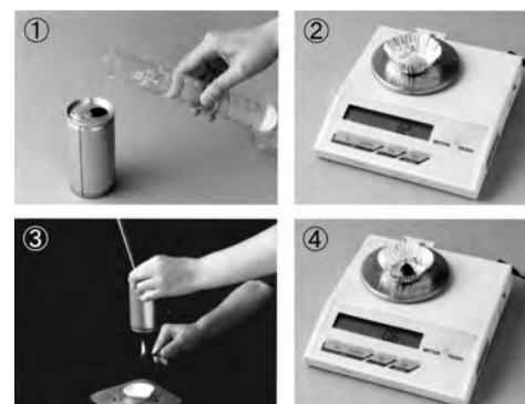
図4 ピーナッツの燃焼実験
