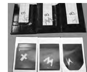
図6 X線照射によって感光したフィルム
