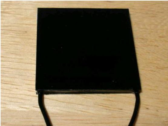
① 電圧をかけたときに、ペルチェ素子の冷える面に黒色のスプレーを吹き付けて乾かす。
