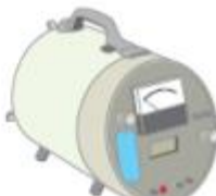
^3\text{He} 計数管式 (中性子線の測定)
