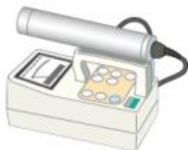
NaI シンチレーション式 (主に低線量の測定)
