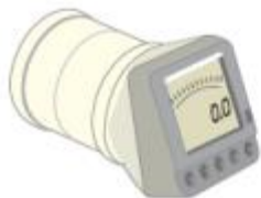
電離箱式 (低～高線量の測定)
