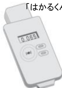
CsI シンチレーション式 (主に低線量の測定)
