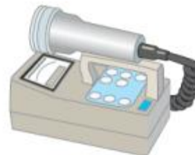
GM 計数管式 (ベータ線の測定)
